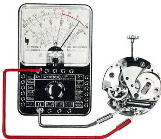
Figure 6 Contrôle stator bobine et diode montés
