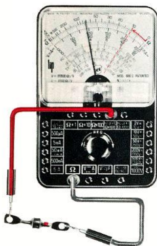
Figure 5 Résistance inverse diode
