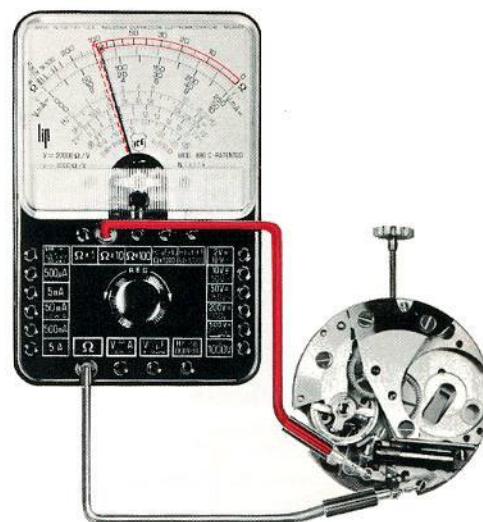
Figure 7 Contrôle stator bobine et diode montés
