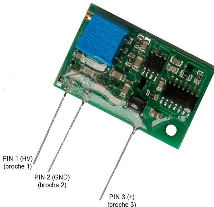
IMEX-38-56-1 est un module de génération haute-tension ajustable pour les tubes Geiger-Müller.
